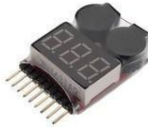
Şekil 14: Örnek Batarya Alarmı
